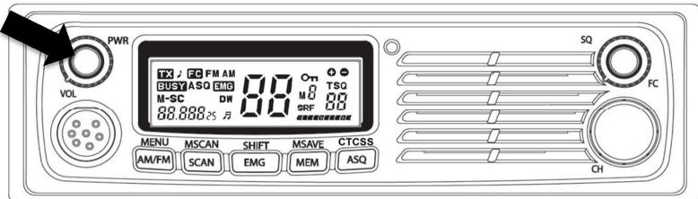
Zum Einschalten und zum Erhöhen der Lautstärke den **Lautstärke-Knopf** nach rechts drehen. Zur Verringerung der Lautstärke und zum Ausschalten nach links drehen.
