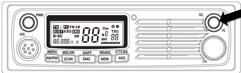
Die Rauschsperrre unterdrückt das Rauschen aus dem Lautsprecher, wenn kein Signal empfangen wird.
