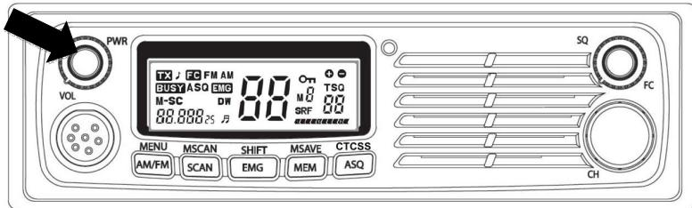
Ruotare la manopola VOL/PWR in senso orario per accendere e regolare il livello del volume per una ricezione confortevole.
