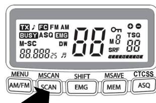
Ora la radio effettua la scansione automatica solo dei canali memorizzati e si arresta quando è rilevato traffico radio.
